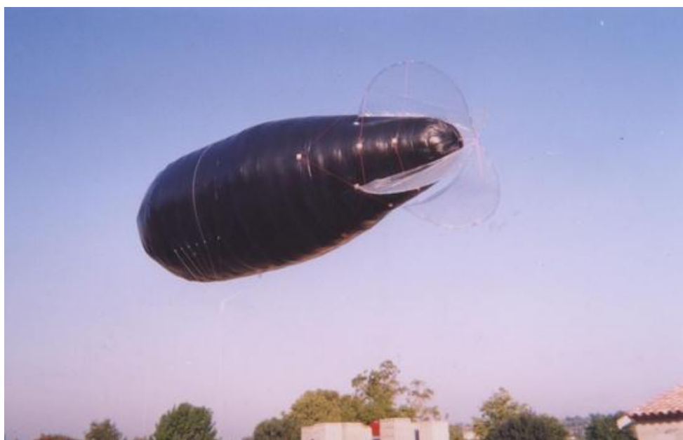
Figure 8 : un dirigeable solaire. On remarque que les ailettes stabilisatrices sont en plastique transparent donc peu visibles.
