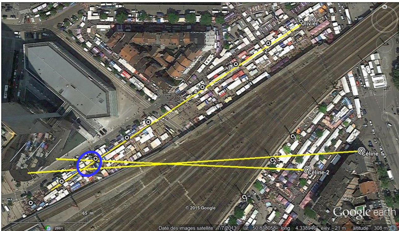
Figure 8 : deux positions possibles de Céline ; en bleu la position de l'objet par triangulation
